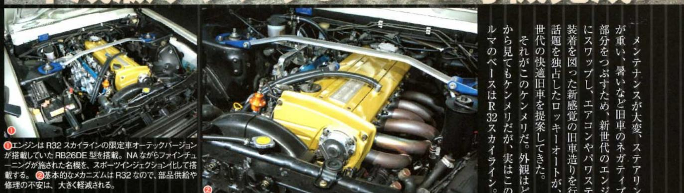
①エンジンはR32スカイラインの限定車オーテックバージョンが搭載していたRB26DE型を搭載。NAながらファインチューニングが施された名機を、スポーツインジェクション化して搭載する。②基本的なメカニズムはR32なので、部品供給や修理の不安は、大きく軽減される。
