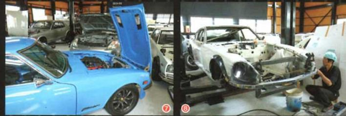
⑥500坪に及び敷地に、400坪の建屋を構えるロッキーオート・スタジオ。来店車両の駐車スペースやエントランスにも大型の庇が設けてあるので、たとえドシャ降りの雨でも濡れずにお店の中まで入ることができる。これもお客さまの利便性を考えての設計。⑦Z33のVQ35型エンジンを搭載したS30Z。手前の水色のZは完成車。奥のZ33はドナー車だ。⑧店内の作業スペースでは、VQ35型を搭載するS30Zを製作中だった。車体のレストア作業と同時に補強が入念に行われ、その後エンジンスワップ等の作業が行われる。
